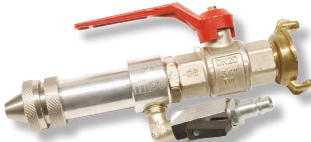
Lancia per la verniciatura professionale a bassa pressione, utilizzabile nel settore dell'edilizia per superfici medio-grandi, adatta a tutti i prodotti liquidi e pastosi con una granulometria fino a 2,5mm. Utilizzabile con la nostra pompa Mistral e con le pompe peristaltiche presenti sul mercato.
