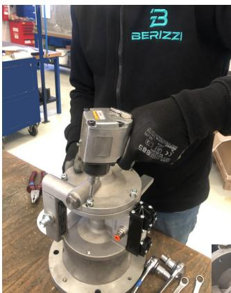
B24 e B24 MIX sono pompe pneumatiche con un basso consumo d'aria. Le valvole sono in acciaio inox, la parte delle membrane in contatto con il materiale è in PTFE o poliammide e, grazie alla progettazione e all'accurata scelta di materiali e componenti, sono macchinari affidabili, di facile manutenzione e consentono una lunga durata lavorativa.
